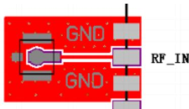
图 5-2 第 11 脚 RF\_IN 连接线设计示意图
