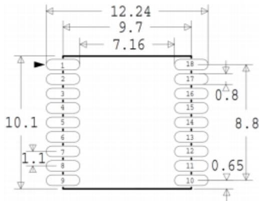
图 3-1 ST210A 模块封装尺寸示意图
