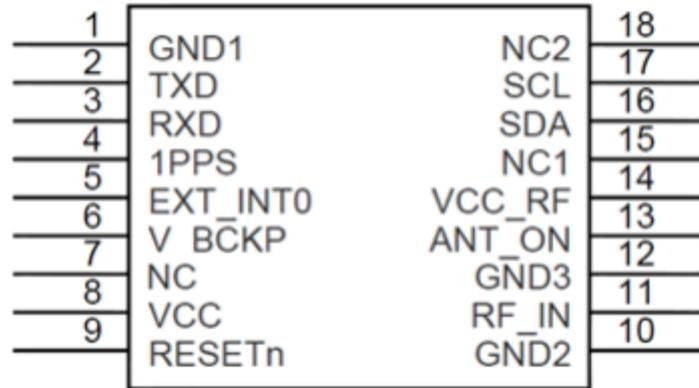
图 3-2 ST210A 模块管脚示意图
