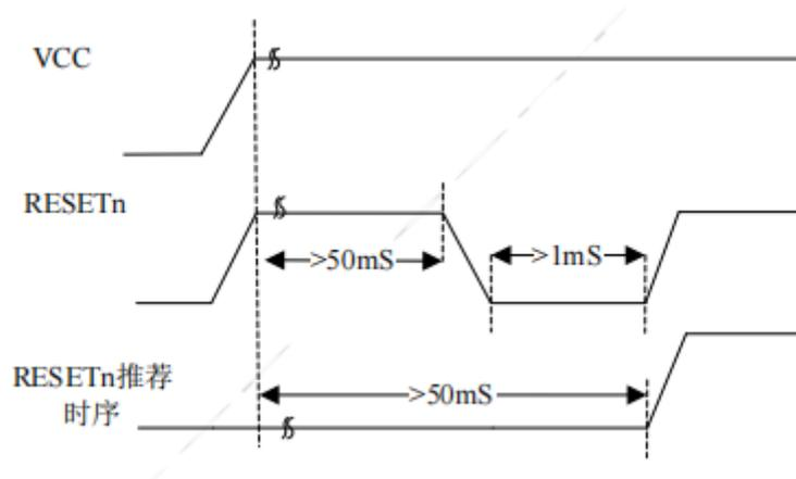
图 2-2 复位信号建议时序图
