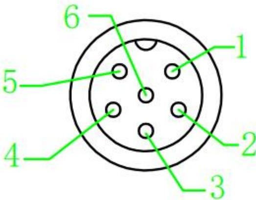
1-供电电源5V正极;2-供电电源负极/公共地;3--串口1\_TX;4-串口1RX;5--USB\_DP;6--USB\_DM
