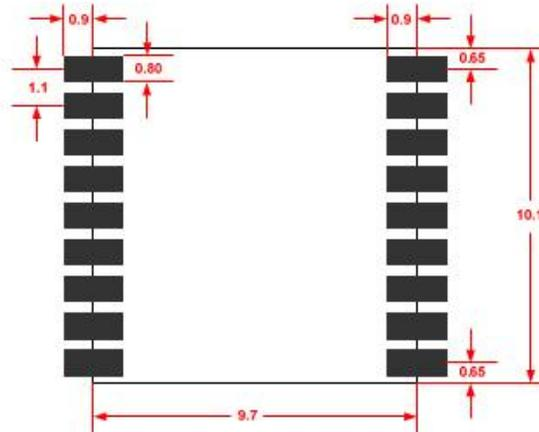
图 2-3 推荐 PCB 封装设计 (单位: mm)
