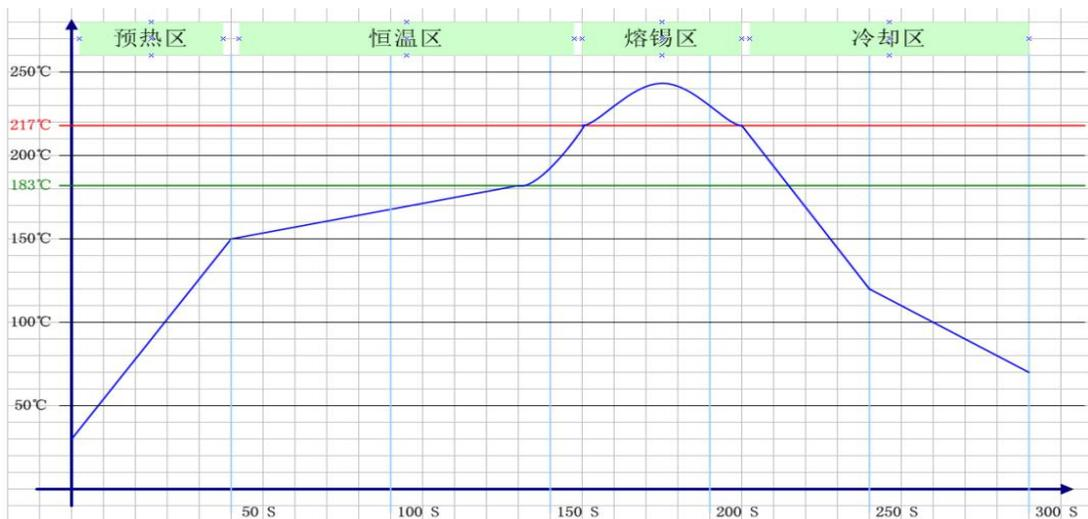
图 4-1 回流焊温度曲线
